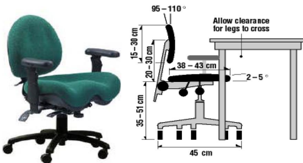
تصویر (۱۵) ابعاد صندلی ارگونومیک جهت استفاده در محیط کار
