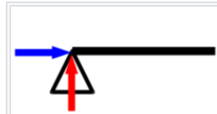
نمایش ترسیمی تکیه گاه مفصلی ثابت (لولایی) به همراه بردارهای واکنش تکیه گاه
