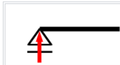
نمایش ترسیمی تکیه‌گاه مفصلی متحرک (غلتکی) به همراه بردار واکنش تکیه‌گاه
