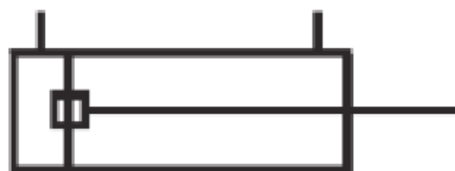
سیلندر تک دسته پیستون با یک بالشتک محکم شده در دو انتها
