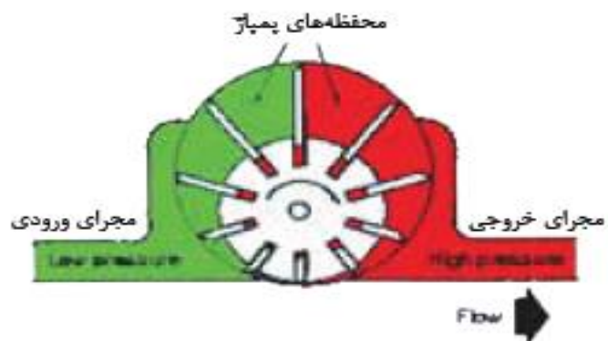
شکل ۳-۹- پمپ با حجم جابه جایی مثبت از نوع رقت و برگشتی
