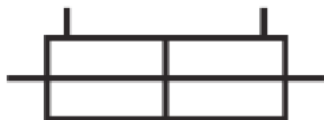
سیلندر با دو دسته پیستون در دو انتها
