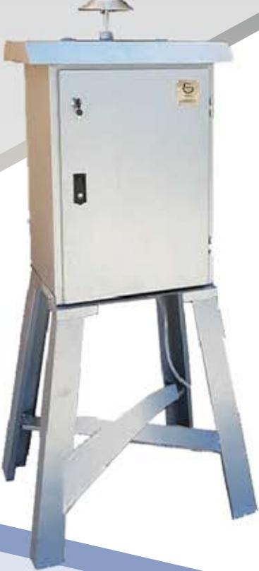
دستگاه پایش لحظه‌ای ذرات معلق محیط (OSPM) جهت اندازه گیری ذرات معلق آلاینده هوا با قطر کمتر از ۱۰۰ میکرومتر (TSP)، کمتر از ۱۰ میکرومتر (PM10) و کمتر از ۲.۵ میکرومتر (PM2.5) به کار می‌رود.
