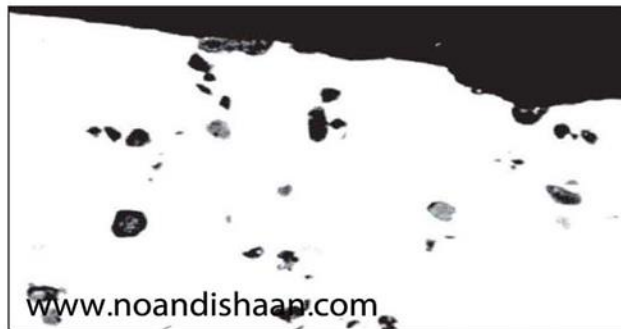
شکل ۷- آلیاژ ۳۸۰ با کوراندوم پراکنده شده که بصورت شن و ماسه به نظر می‌رسد. احتمالاً ریختگی پس از تمیز نمودن کوره انجام شده.
