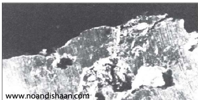
شکل ۲- قطعه‌ای که شامل سربار مواد می‌باشد. این سربار از ملاقه به قطعه منتقل شده است.
